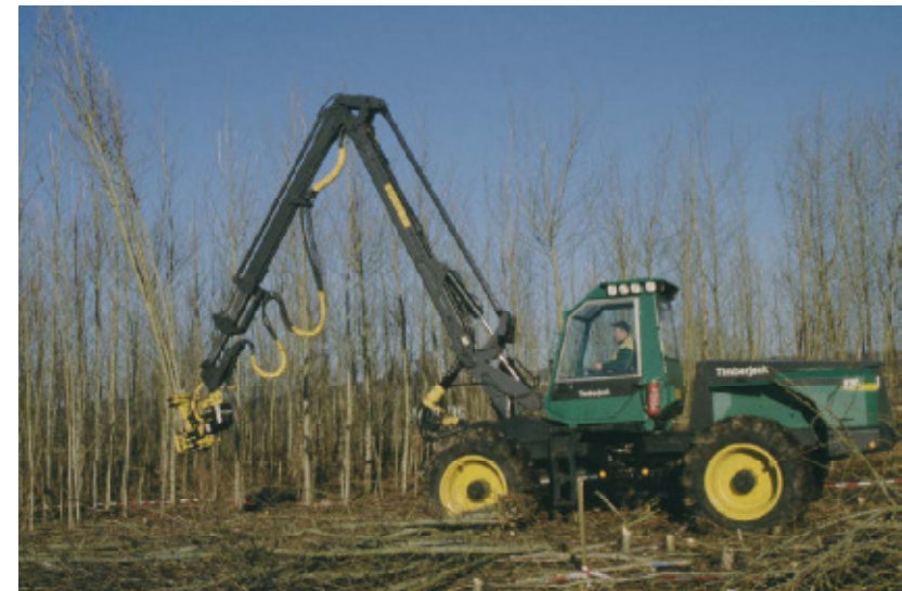
Fäll-Bündler-Kopf von TJ 720 Timberjack Flächenleistung: 0,07 bis 0,10 ha/h
