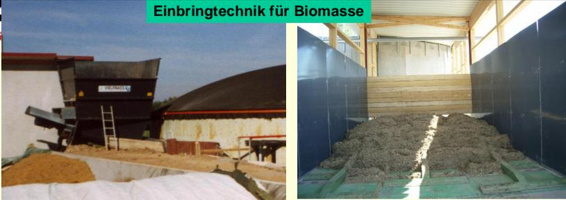
Über den **Feststoffeintrag** wird die tägliche Biomasse (Silomais, Getreide, Grassilage,...) alle 30 min in den Fermenter eingebracht
